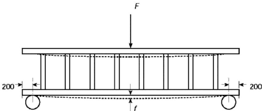
Рис.5. Испытания на боковой прогиб
