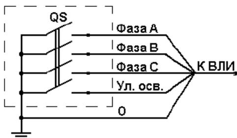
Рис.13. Схема стационарного устройства заземления
