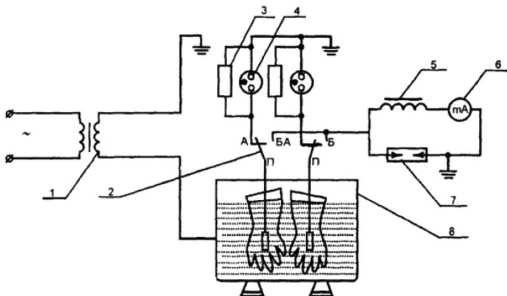
Рис.11. Принципиальная схема испытания диэлектрических перчаток:
