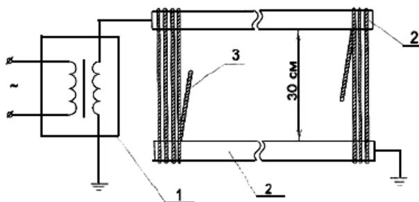
Рис.3. Схема электрических испытаний изолирующего каната:
