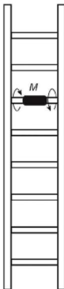
Рис.7. Испытания на кручение перекладин и ступеней
