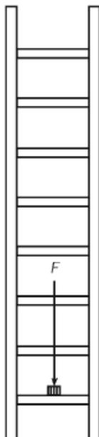
Рис.6. Испытание на изгиб перекладин/ступеней
