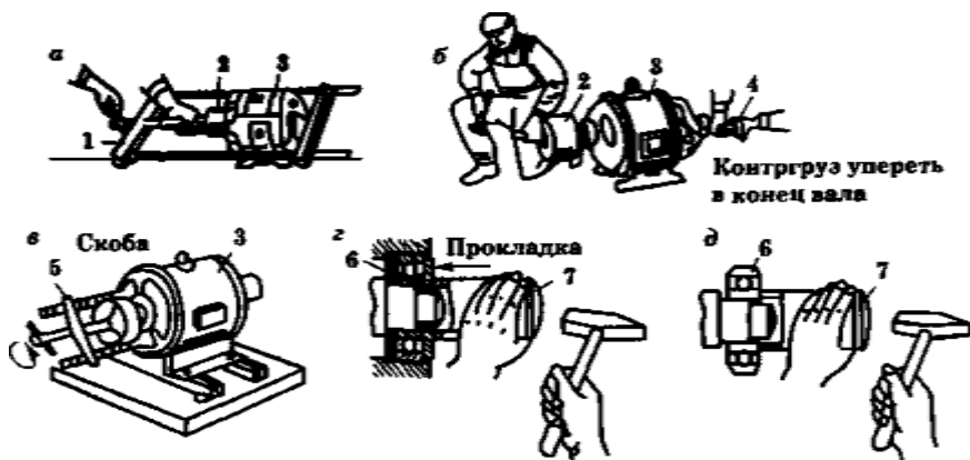
Рис. 5.2. Способы насадки шкивов и подшипников на вал: а — винтовым приспособлением; б — молотком с применением контргруза; в — снятие шкива съёмником; г — посадка подшипника в гнездо; д — посадка подшипника на вал; 1 — винтовое приспособление; 2 — шкив; 3 — электродвигатель; 4 — контргруз; 5 — съёмник; 6 — подшипник; 7 — труба с
