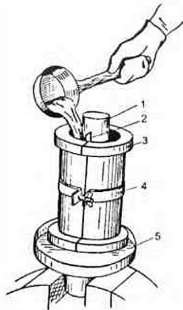
Рис. 2.44. Ручная заливка баббитом подшипника скольжения: 1 — стержень; 2 — прокладка; 3 — вкладыши подшипника, подготовленного к заливке; 4 — хомут; 5 — поддон
