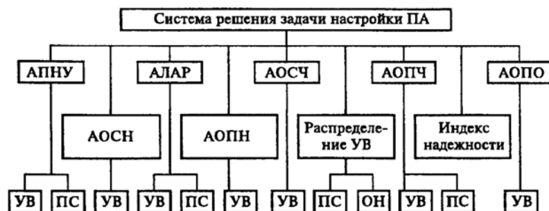
Рис. 6.2. Комплекс противоаварийной автоматики
